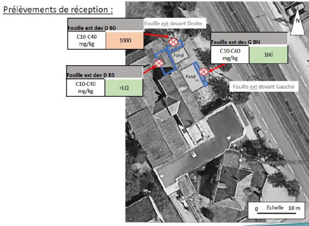
FIGURE 10 : SYNTHÈSE DES RESULTATS DE RECEPTION DES TRAVAUX DE DEPOLLUTION MENES EN 2024 (SOURCE : NOTE TECHNIQUE SOCOTEC 2024)
